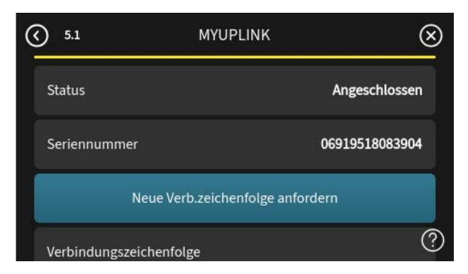
Es macht keinen Unterschied, ob Sie die Wärmepumpe per Smartphone oder PC mit Ihrem myUplink Konto verknüpfen. Mit jedem Gerät, bei dem sie auf myUplink eingeloggt sind, können Sie danach auf Ihre Wärmepumpe zugreifen.
