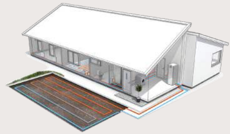
Wärmepumpe mit Direktverdampfer
